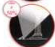
Proiettore per illuminazione di monumenti o grandi aree con puntamento e/o inclinazione errata
